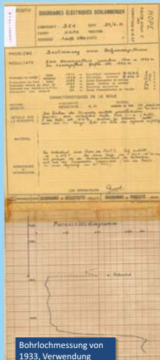
Temperaturmessung in der Bohrung Nienhagen von 1933.
