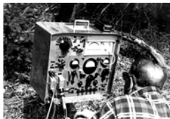
Einsatz der Geoelektrik (die verschiedenen Sonden konnten durch den Drehknopf oben links bequem zugeschaltet werden!)
