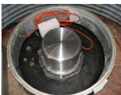
Heute: STS2 Seismometer mit spezieller Ummantelung
