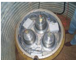
Ab 1976: 3 Komponenten STS1 Seismometer
