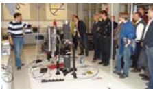
1986 Absolute Gravimeter nach dem Präzisionsprinzip als Basis für das Österreichische Schwergründnetz des Bundesamts für Eich- und Vermessungswesen (BEV).
