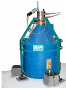
1995 Superleitendes Gravimeter (GWR CoS) in Wien installiert – Zusammenarbeit ZAMG/IMGW. Seit 2007 am Conrad Observatorium.
