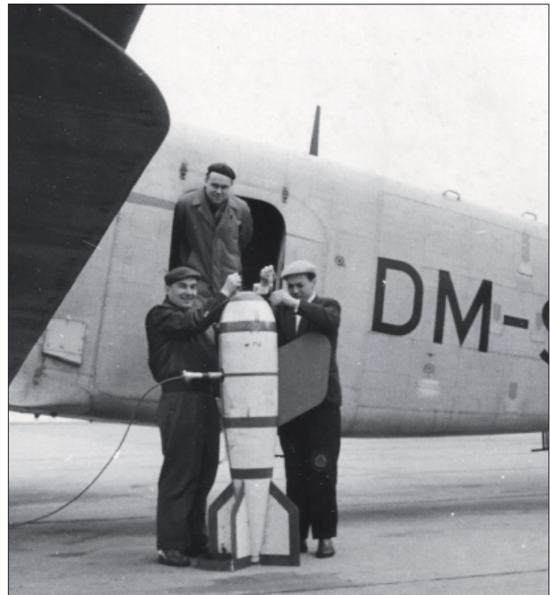
Abb. 4: Magnetik-Schleppkörper mit eingebautem Kernpräzessionsmagnetometer vor AN-2 auf dem Flughafen Leipzig-Mockau 1961 (in der Bildmitte der Autor G.W.) (Quelle: G. Weimert).
