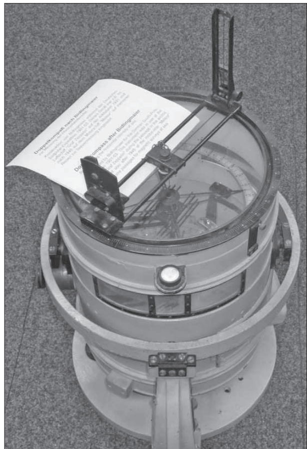
Abb. 3: Doppelkompass von Bidligmaier (im Einsatz bei: Deutsche Südpolar-Expedition mit der „Gauß“ 1901-03, Arktisfahrt mit LZ 127 „Graf Zeppelin“ 1931, Fahrten mit „Meteor“ nach 1945).
