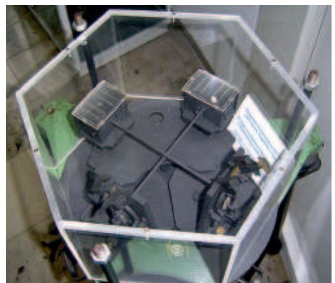
Abb. 4: Horizontalpendel nach Oskar Hecker im GeoForschungsZentrum Potsdam.
