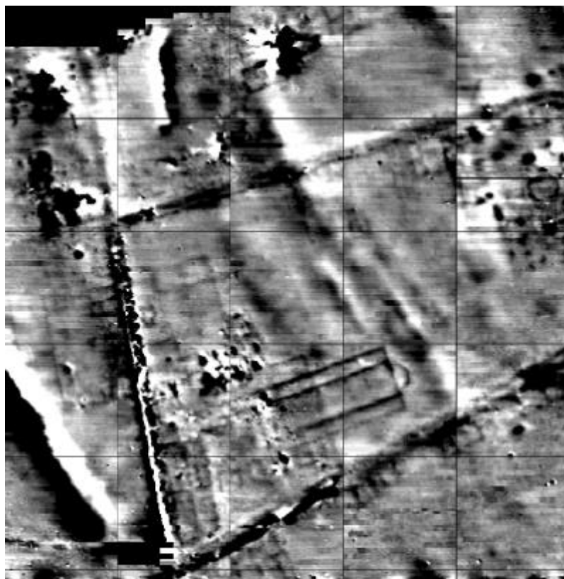
Abb. 8 Ostia Antica 1996. Magnetogramm (Ausschnitt) mit der Basilika von Konstantin I. Cäsiummagnetometer SM4G-Special in Quadro-Sensor Konfiguration, Empfindlichkeit \pm 10 Picotesla ( 10 \text{ pT} = 0.01 Nanotesla nT), Dynamik - 50.0/+50.0 nT in 256 Graustufen (weiß / schwarz), Raster nach Resampling 0.5/0.25 m, 1 Hz Bandpaßfilter, Reduktion der Tagesvariation durch Zeilenmittel, 40m-Gitter, BLfD Magneto-meterprospektion, Mag. Nr. OS96-A
