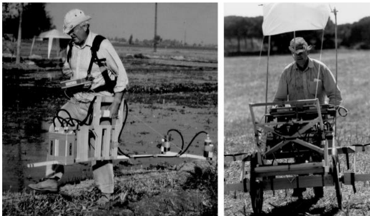
Abb. 1 Qantir Piramesse 1996. Cäsium Magnetometer SMARTMAG SM4G-Spezial des Bayer. Landesamtes für Denkmalpflege in Duo-Sensor Konfiguration.
