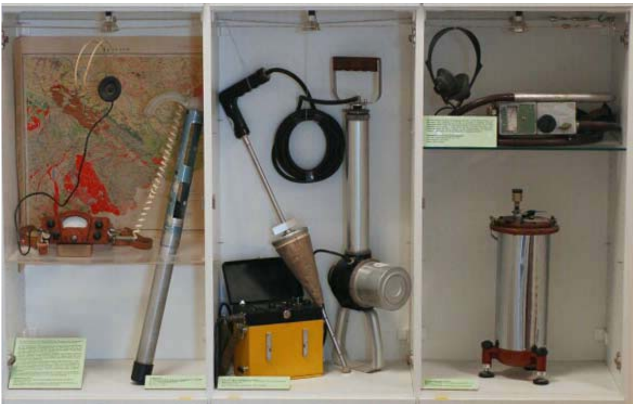
Abb. 1: links: Feldradiometer SRP-2 (UdSSR 1969), Mitte: Szintillationsemanometer (Bodenluftmessgerät) mit manueller Luftpumpe (UdSSR 1987), rechts oben: das weit verbreitete Hauerradiometer UNIRAD (SDAG Wismut 70er Jahre) und rechts unten: ein Quarzfedergravimeter GNU-K2 (Moskau 1979). Ober- und unterhalb der Glasvitrinen befinden sich Regalschränke mit Material des DGG-Archivs. (Foto: F. Bach)
